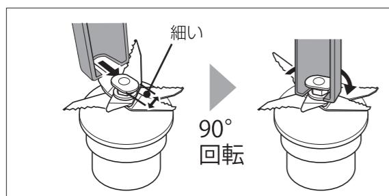
ブレード組立の中心部は少し楕円形になっております。ブレード組立脱着治具の柄部分先端をブレード組立の中心部にひっかける際は、楕円形の細い方からブレード組立脱着治具の柄部分先端を合わせて、回転させてひっかけて安定させてください。
