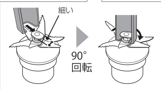
ブレード組立の中心部は少し橢円形になっております。ブレード組立脱着治具の柄部分先端をブレード組立の中心部にひっかける際は、橢円形の細い方からブレード組立脱着治具の柄部分先端を合わせて、回転させてひっかけて安定させてください。
