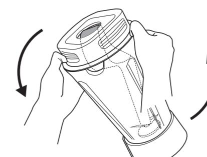
ブレード組立脱着治具とブレード組立が外れていない事を確認してください。
