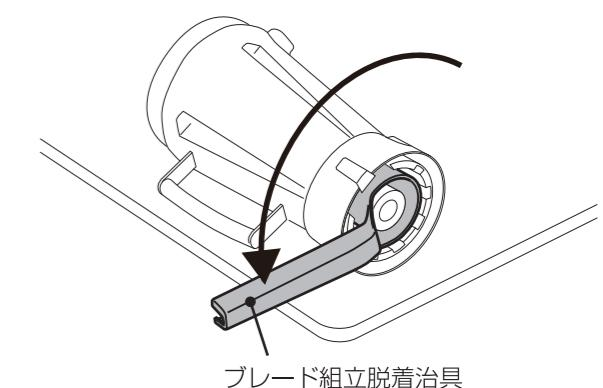
ブレンダーボトルにダイキャストカバーとブレード組立がきちんと装着されたかの確認のため、装着後ブレンダーボトルに水を入れ、漏れがないか確認してください。
