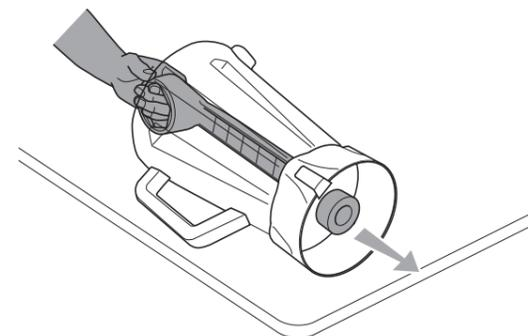
3 片手でブレード組立脱着治具持ち、ブレードを安定させます。もう一方の手でダイキャストカバーをブレンダーボトル底面の突起を合わせるようにはめ込み、ブレード組立ワッシャーを取り付け、ブレード組立リングを反時計回りに回しつけます。
