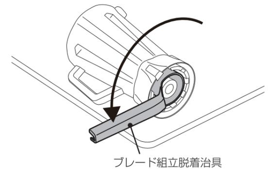
ブレンダーボトルにダイキャストカバーとブレード組立がきちんと装着されたかの確認のため、装着後ブレンダーボトルに水を入れ、漏れがないか確認し、すすいでください。
