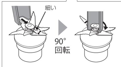
ブレード組立の中心部は少し楕円形になっております。ブレード組立脱着治具の柄部分先端をブレード組立の中心部にひっかける際は、楕円形の細い方からブレード組立脱着治具の柄部分先端を合わせて、回転させてひっかけて安定させてください。
