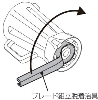
2 ブレード組立リングが少しゆるんだら、ブレード組立脱着治具をリングから一旦外し、図のように柄部分先端にブレード組立をひっかけます。
