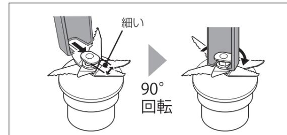
ブレード組立の中心部は少し楕円形になっております。ブレード組立脱着治具の柄部分先端をブレード組立の中心部にひっかける際は、楕円形の細い方からブレード組立脱着治具の柄部分先端を合わせて、回転させてひっかけて安定させてください。
