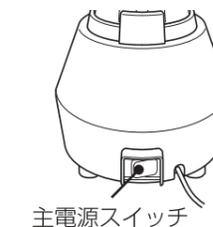
**⚠ 注意** ●使用時以外は主電源スイッチを OFF にするか、主電源スイッチを OFF にしてから電源プラグをコンセントから抜く。
