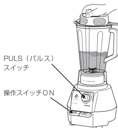
5 出来上がったら操作スイッチ OFF を押し、運転を止め、主電源スイッチを OFF にする。
